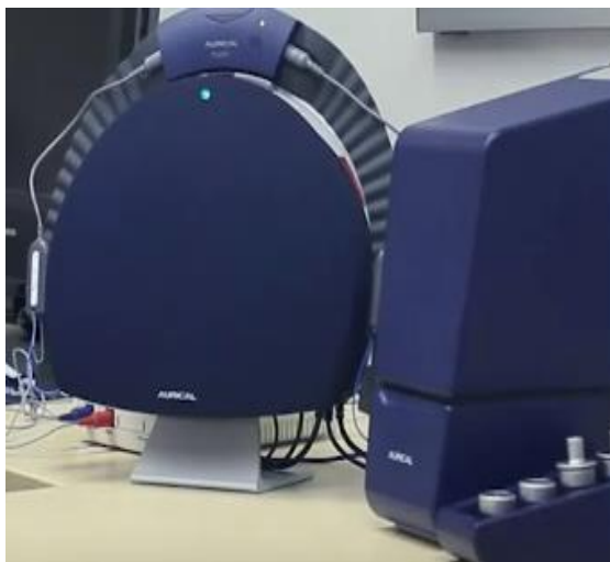
Рисунок 15 – Система тестирования и подбора слуховых аппаратов Auricle Plus (GN Otometrics, Дания)
