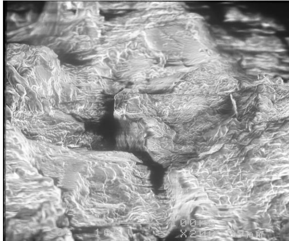
Рисунок 140 – Поверхность вкладыша из силикона, срок эксплуатации – 24 месяца, неровные контуры поверхности, образование трещин и «пещер» Фото 14; ускоряющее напряжение – 10KV; увеличение x 200; длина метки – 100 \mu\text{m} (мкм); фокусное расстояние – 38 мм.
