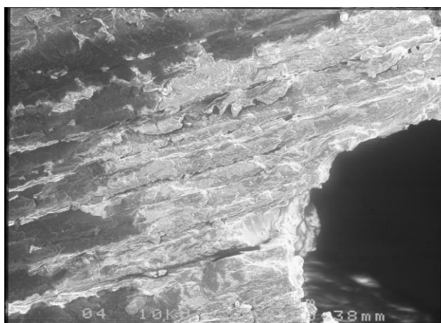
Рисунок 143 – Поверхность вкладыша из вариофлекса, срок эксплуатации – 11 месяцев, вид со стороны медиального отверстия звуковода, дефект поверхности от грубой обработки бором, неровные контуры поверхности
